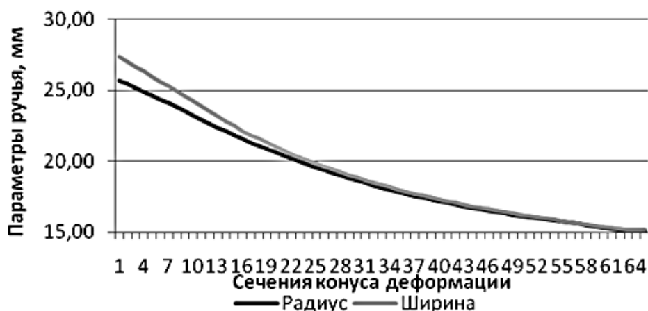
Рис. 1. Параметры ручья калибров стана ХПТ-32 (маршрут 24 \times 4,1-15,1 \times 2,4 , сплав Gr2)
